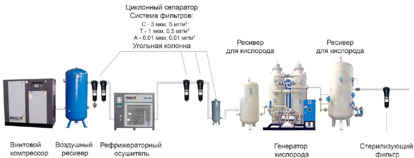
ВАРИАНТ 2: С РЕФРИЖЕРАТОРНЫМ И АДСОРБЦИОННЫМ ОСУШИТЕЛЕМ.
