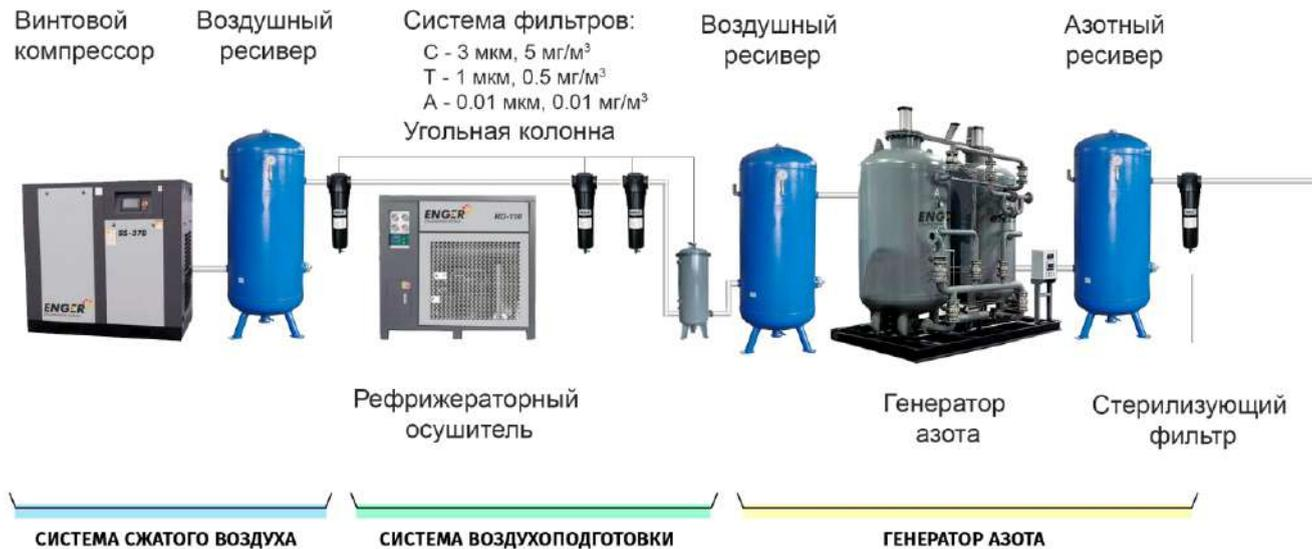
ВАРИАНТ 2: С РЕФРИЖЕРАТОРНЫМ И АДсорбЦИОННЫМ ОСУШИТЕЛЕМ.
