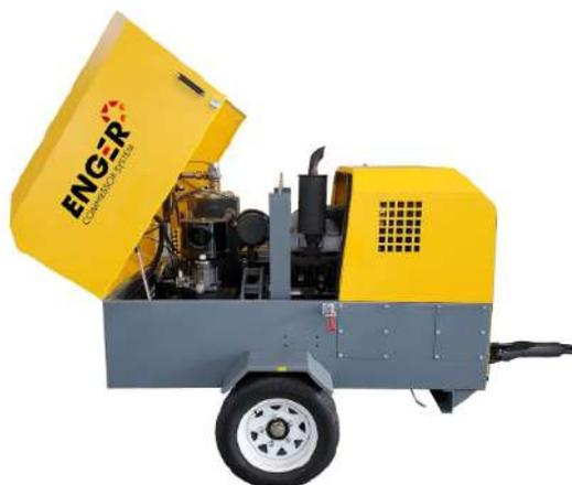
**НАДЕЖНОСТЬ. Винтовой блок VAOSI.** Асимметричные роторы повышают эффективность, а низкая частота вращения и минимум движущихся элементов сводят к минимуму износ, обеспечивая длительный срок службы.
